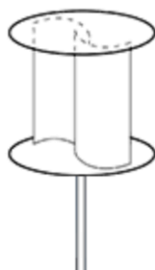
Figuur 37. principe Savonius-windturbine; prototype in het SWT Field Lab van UGent
